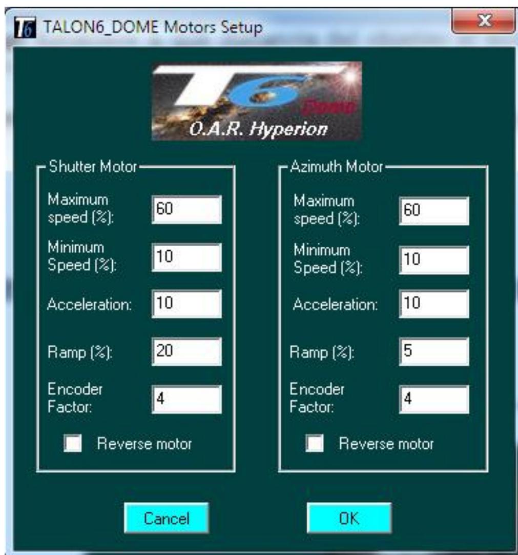
**Fig. 18. Motors Setup**
